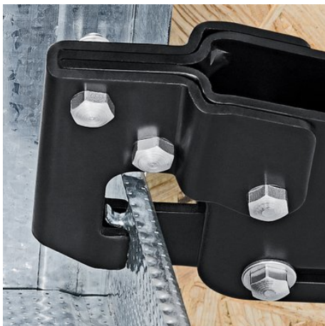
Пуансон инструмента продавливается через профили
