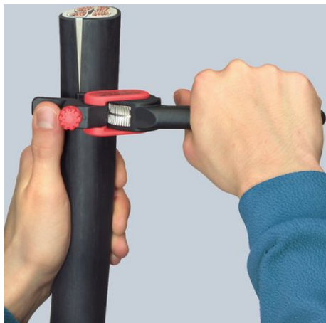
Вращение инструмента для разреза по окружности
