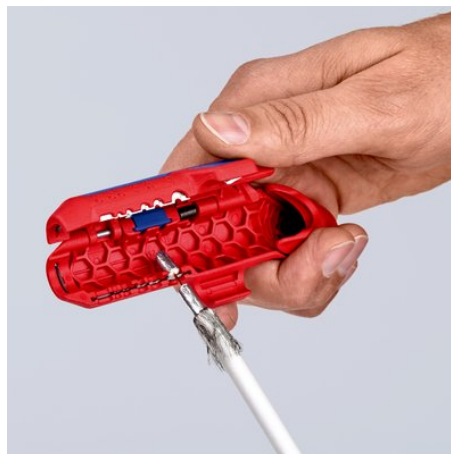
Удаление изоляции с коаксиального кабеля
