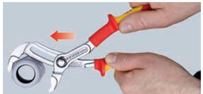
Для регулировки клещей просто нажмите на их ручку.
