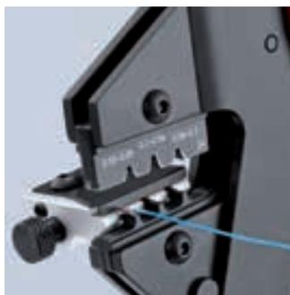
KN-9743400 с опрессовочными плашками KN-974924 и направляющей KN-974993 для штекеров D-Sub.
