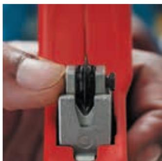
Опирающийся на игольчатый подшипник подпружиненный режущий диск из высококачественной шарикоподшипниковой стали легко заменить.
