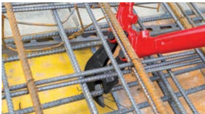
Особая форма головки ножниц для резки арматурной сетки KN-7182950 позволяет резать горизонтально лежащую арматуру.
