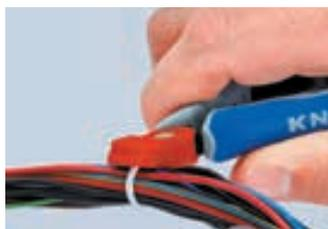
Срезание замка кабельной стяжки с помощью бокорезов для электроники.
