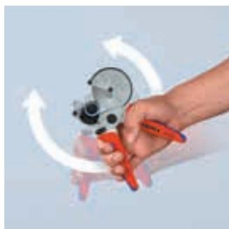
Процесс резки очень прост: вращающийся режущий диск позволяет поворачивать трубу в труборезе с минимальным трением или наоборот поворачивать труборез вокруг трубы.
