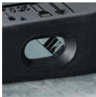
Квадратное опрессовочное гнездо для контактных гильз 0,25–4 мм<sup>2</sup>.
