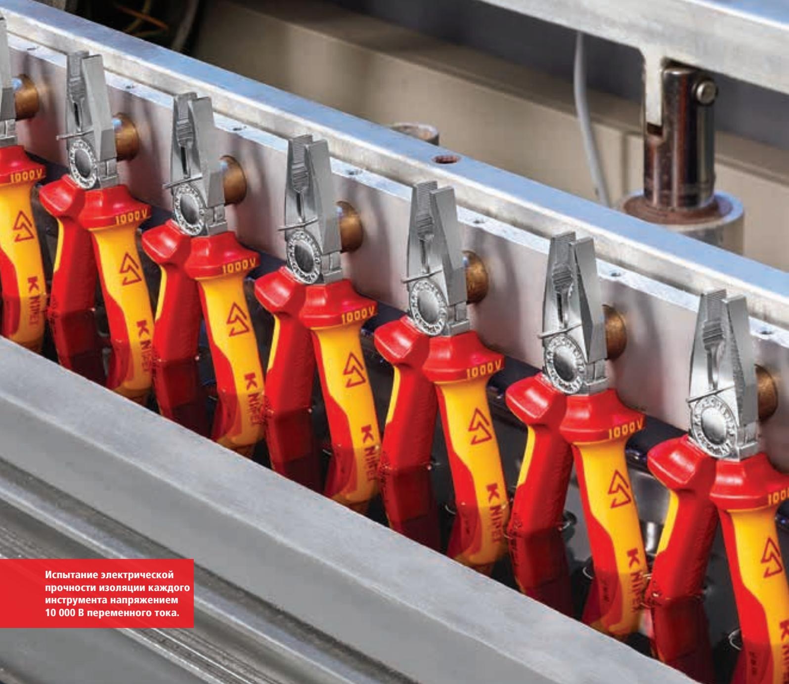
Испытание электрической прочности изоляции каждого инструмента напряжением 10 000 В переменного тока.
