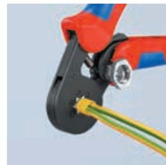
Инструмент подходит в том числе и для любых двоядных контактных гильз сечением до 2 x 10 мм<sup>2</sup>.
