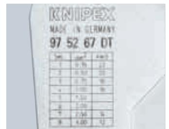
Хорошо видимые обозначения для установки переключателя глубины опрессовки на клещах.
