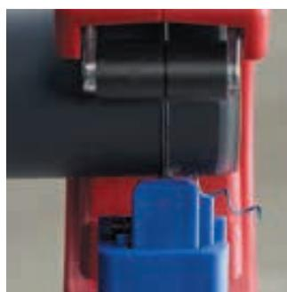
Можно отрезать сегменты размером всего 10 мм. При снятии фаски образуется спиральная стружка.
