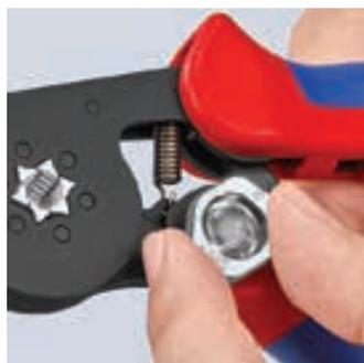
Регулировочное колесико позволяет настроить пресс-клещи для опрессовки крупных контактных гильзы с поперечным сечением 16 мм<sup>2</sup> или 2 x 10 мм<sup>2</sup>.
