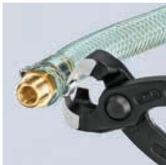
Герметичное крепление хомутом пневматического шланга штуцере для быстръемного соединения.
