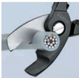
Вторичный рез: после срезания оболочки с помощью переднего профиля, отрезаются провода с помощью заднего профиля. Для максимального облегчения работы первичный рез выполняется с помощью переднего профиля, а вторичный — с помощью заднего.
