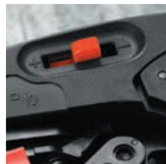
Точная регулировка позволяет надежно удалять изоляцию даже в особых условиях (специальные изоляционные материалы или экстремальные температуры).
