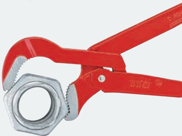
Размер накладной гайки 2 дюйма выше, чем ширина захвата трубного ключа 2 дюйма, поэтому ее нельзя надежно захватить таким инструментом
