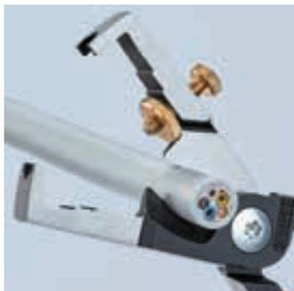
Лезвия резака с индукционной закалкой и прецизионной заточкой режущих кромок для резки медных и алюминиевых кабелей до Ø 15 мм (5 x 2,5 мм<sup>2</sup>) без раздавливания.
