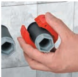
Уникальная конструкция поворотного блока с лезвием позволяет надежно отрезать канализационные трубы и уплотнительные втулки на расстоянии 2–3 мм от стены для обеспечения надежного отвода влаги.
