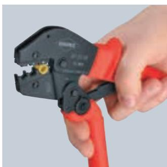
Первый шаг: сжать ручки двумя пальцами, пока обе губки не коснутся обжимаемого соединителя (наконечника).
