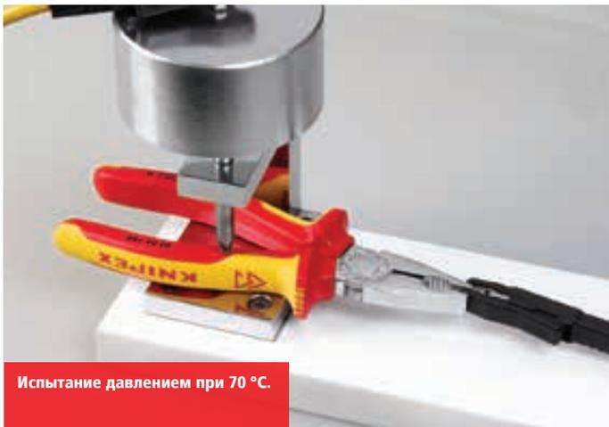
Испытание давлением при 70 °С.
