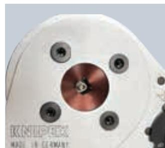
Синхронная подача 4 обжимных оправок обеспечивает оптимальный результат опрессовки с восемью углублениями (4/8 выемок).
