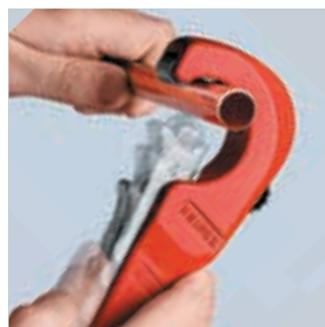
Механизм фиксации QuickLock позволяет одной рукой прижать режущий диск к трубе: максимально быстрая настройка для резания труб разного диаметра.
