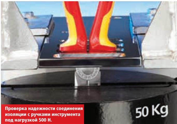
Проверка надежности соединения изоляции с ручками инструмента под нагрузкой 500 Н.
