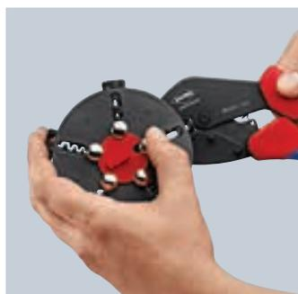
Смена опрессовочных плашек: разблокировать магазин, извлечь ранее установленные плашки из пресс-клещей.
