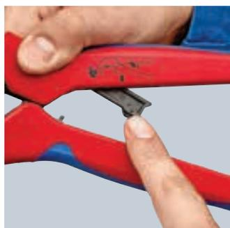
Задвинуть вспомогательный рычаг и сжать клещи до упора. Инструмент готов к применению.
