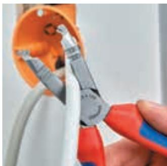
Резание кабеля диаметром до 13 мм.
