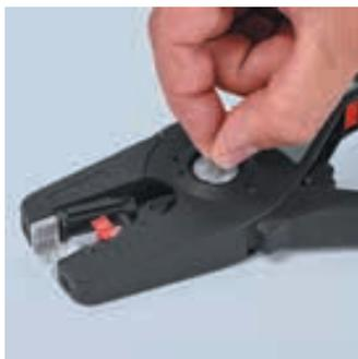
В особых случаях, например для снятия очень жесткой или мягкой изоляции, можно оптимально точно настроить инструмент с помощью регулировочного колесика, которое имеет ряд хорошо ощутимых фиксированных положений.
