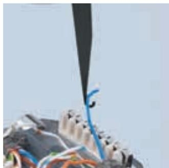
Со встроенным крючком для протяжки.
