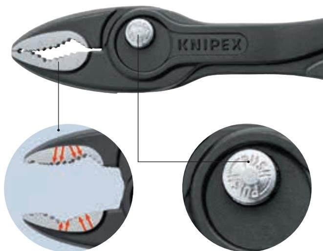
Оптимизированная геометрия губок: 2-зонные губки с противоположно направленными зубьями для максимально эффективного захвата при ослаблении и затягивании
