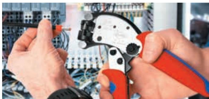
Опрессовочная головка может поворачиваться на 360°, обеспечивая наилучший доступ даже в ограниченном пространстве.
