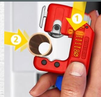
... установите шкалу и закрепите на трубе с помощью подпружиненного режущего диска
