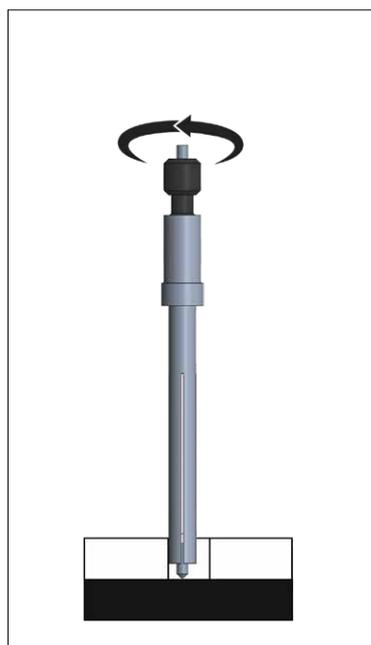
1. Вставить центровочный кернер подходящего размера в отверстие, вращать накатанную головку
