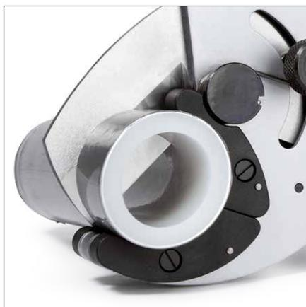
Предотвращение холостых резов благодаря автоматическому подводу ножа на соответствующий диаметр трубы
