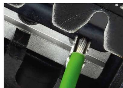
Поворотный приемник для контактов служит для точного выравнивания и фиксации контакта, а также в качестве ограничителя для кабеля. В сочетании с параллельной подачей обжимных губок и принудительным завершением процесса обжима создается идеальное обжимное соединение.
