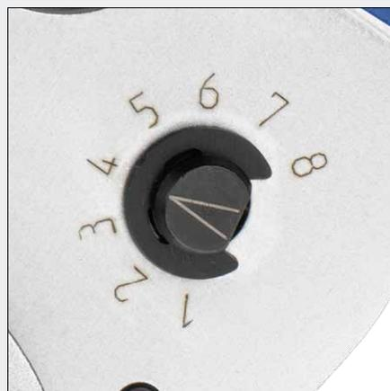
Положение селектора считывается с обеих сторон клещей.
