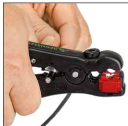
Резка коаксиального кабеля
