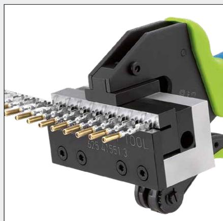
Инструмент для отрезания отдельных контактов от ленты (ленточного товара)
