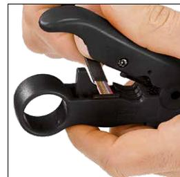
Снятие изоляции с плоского ленточного кабеля
