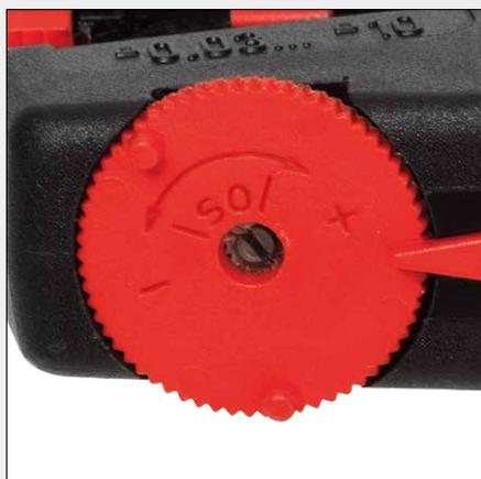
Тонкая регулировка глубины реза
