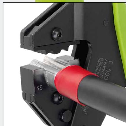
Обжимные клещи с системным размером 16 мм для технологической обработки больших концевых клещей
