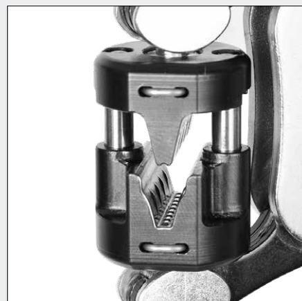
Модель Twistor® T – Обжимной профиль трапециевидной формы
