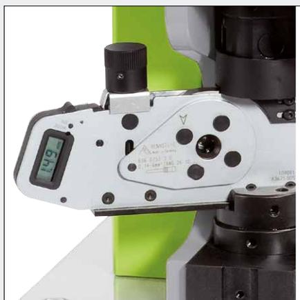
Тетрагональный обжимной блок с цифровым дисплеем
