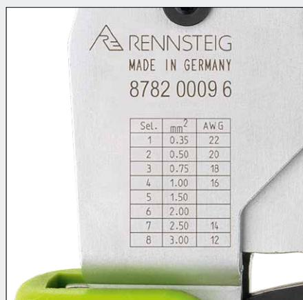
Положение селектора для установки глубины обжима легко читается на клещах
