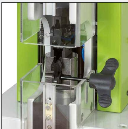
Обжимной станок CM 25-2 для обработки экранированных штекерных соединителей
