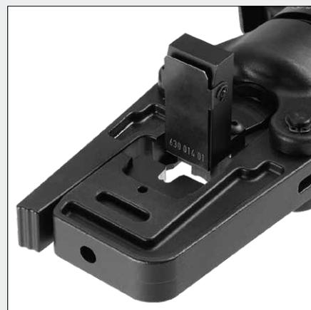
Доступны приемники для контактов для специальных опрессовочных плашек
