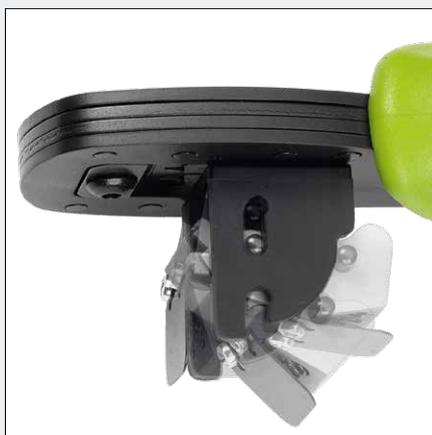
Поворотный многофункциональный приемник для контактов из алюминия
