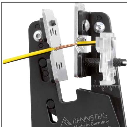
Снятие изоляции с помощью фасонных ножей
